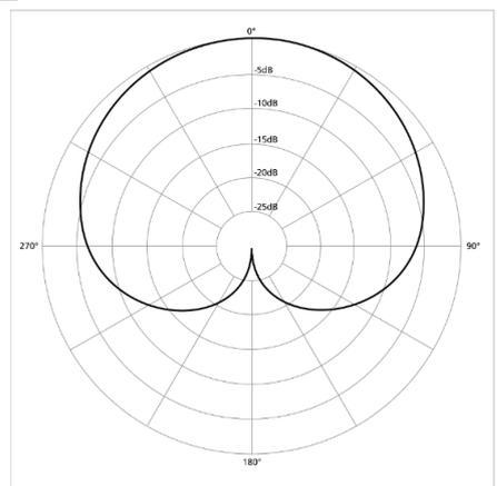
Le microphone utilisé ici est de type cardioïde, donc directionnel.
